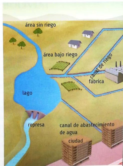
Esquema del sistema de riego en ambientes desérticos.
